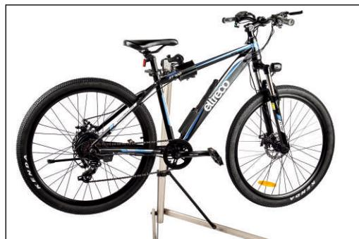
Установите аккумулятор, предварительно произведя его полную зарядку. Проверьте все разъёмы: мотора, дисплея, ручки газа, ручек тормоза. Они должны быть прочно и надёжно соединены. Если Вы обнаружили разъединённый разъём, необходимо его соединить по указанным на корпусе разъёма стрелочкам.
