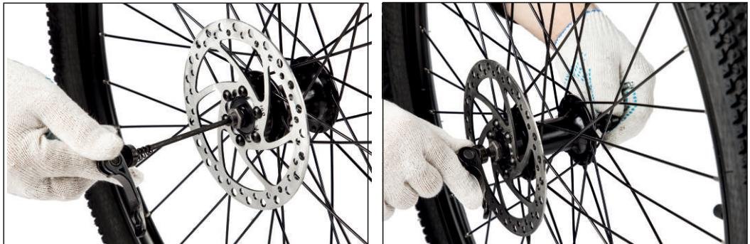
Затягиваем эксцентрик со средней силой. Затем протягиваем рулевой стакан. Проверяем, чтобы он не болтался, но в то же время крутился свободно
