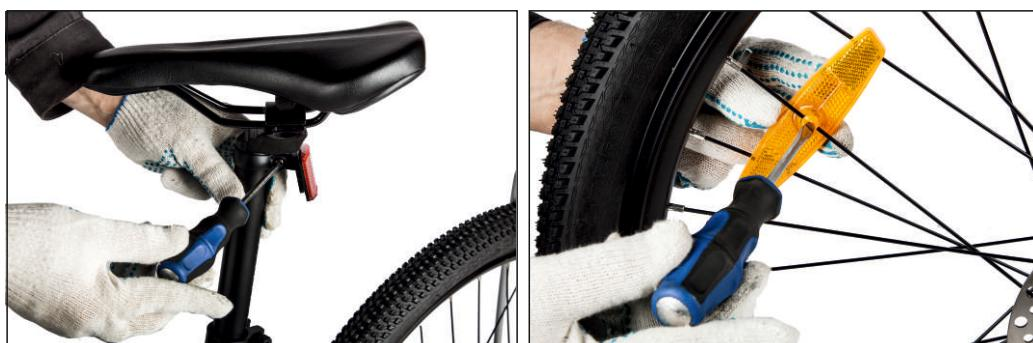
Прикрутите отражающие катафоты из комплектации на спицы и другие соответствующие части велогибрида, установите крылья и багажник, если они поставляются в комплектации с Вашей моделью велогибрида.
