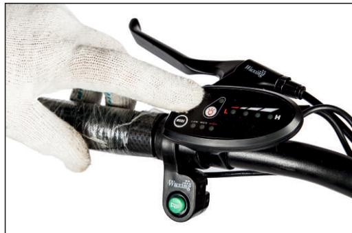
Если в Вашем аккумуляторе есть ключ зажигания, поверните его в положение «вкл». Проверьте работоспособность велогибрида, нажав кнопку включения на пульте управления или велокомпьютере, расположенному на руле. Велогибрид активируется - об этом будет свидетельствовать включение индикации на велокомпьютере.
