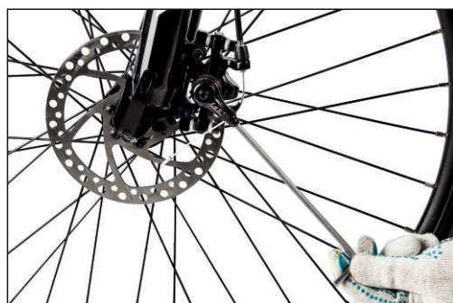
Следом устанавливаем сам калипер. Важно отцентровать его относительно тормозного диска. Далее прикручиваем гидролинию к вилке, во избежание ее попадания в колесо. Вставляем тросики переключения скоростей, протягиваем их вдоль вилки.
