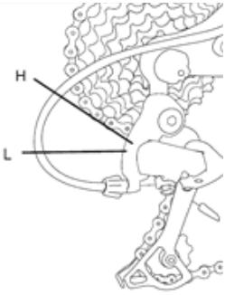
Шаг 1: убедитесь в том, что задний механизм переключения передач установлен на самой маленькой звездочке.
