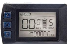
**Управляющий велокомпьютер** OMT-M3 с LCD-дисплеем является универсальным много-функциональным устройством для управления велогибридом с возможностью широкой настройки показателей, управляющих функций и многих параметров. Подробнее о функциях и настройке велокомпьютера читайте в следующем разделе.
