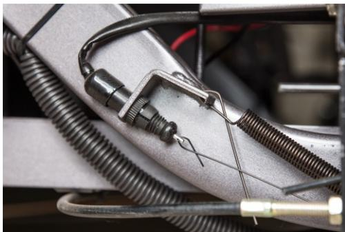
Время от времени проверяйте исправность выключателя стоп-сигнала, расположенного с правой стороны под грузовой платформой.
